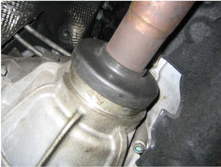
Getriebeflansch rechts und Antriebswelle
