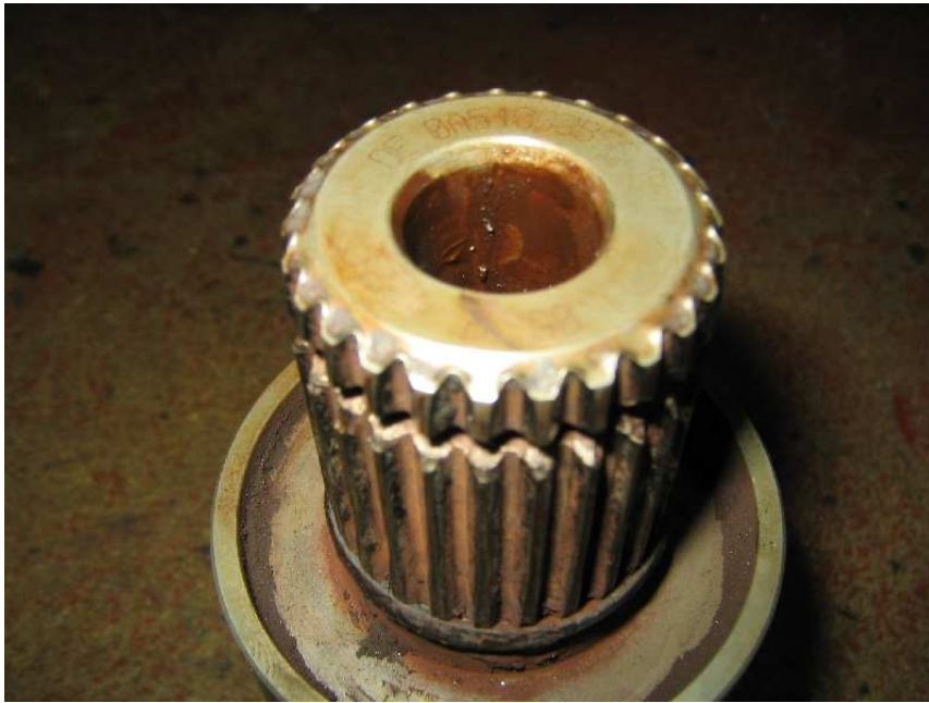
die alte Steckwelle, leider sieht man im Bild nicht wie die Zahnung bogenförmig läuft
