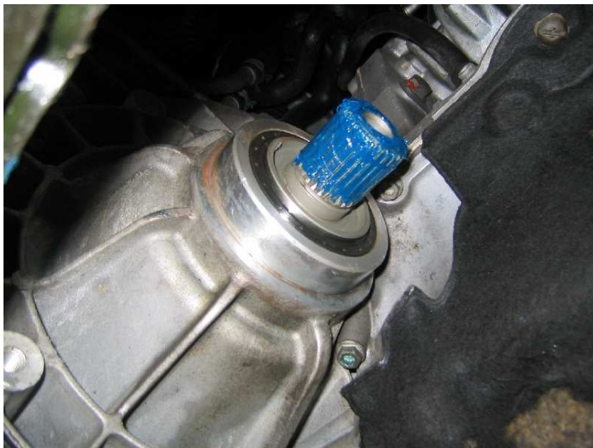
die neue Steckwelle bereits eingebaut, noch ohne O-Ring und Sicherungsring
