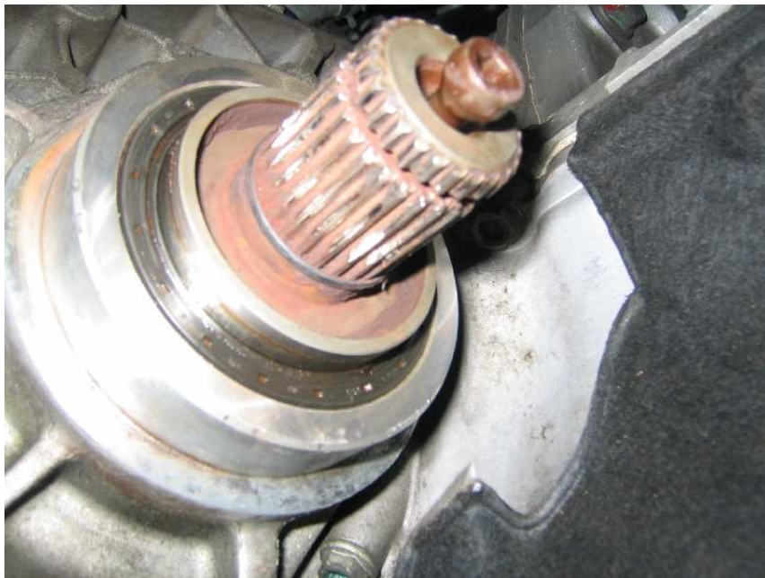
die Steckwelle mit gelöster Schraube
