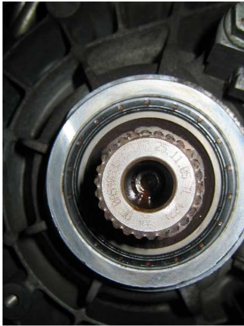
die Steckwelle, Befestigungsschraube innen
