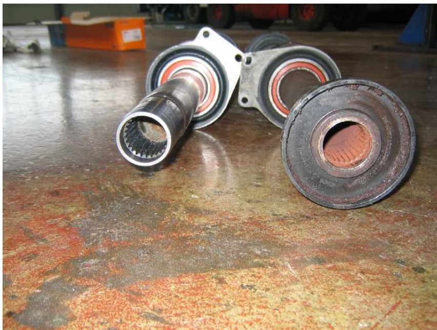
im Vergleich, des weiteren hat die alte Welle in ihren Gleichlaufgelenken etwas Spiel
