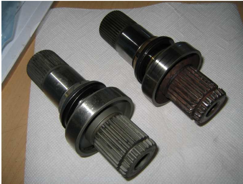
die Neue mit trapezförmiger Zahnung, die Alte mit ausgelutschter spitzer Zahnung
