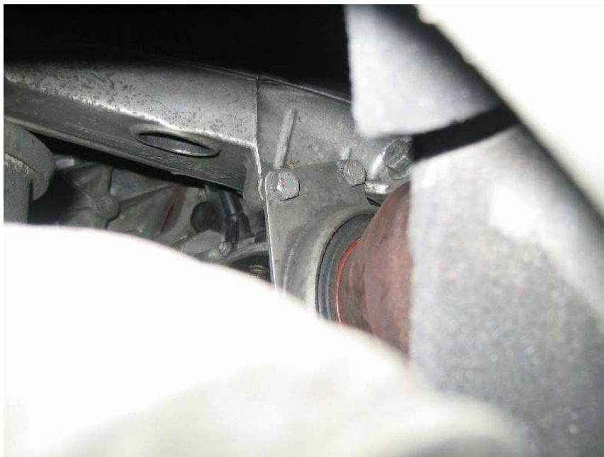
Schrauben der Wellenaufhängung demontieren, dazu das mittlere Plastikteil im Radhaus demontieren
